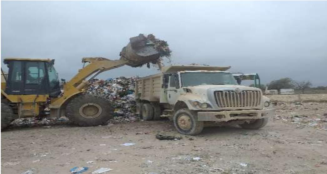
DURANTE TODO EL MES, CADA DIA SE REALIZAN LOS TRABAJOS DE ABUNDAMIENTO DE RESIDUOS; ESTOS TRABAJOS SE REALIZAN DIARIAMENTE. DICHS TRABAJOS LOS REALIZAN LOS OPERADORES DE MAQUINARIA Y CONSISTEN EN ABUNDAR LOS RESIDUOS SOLIDOS CON LA MAQUINA RETROEXCAVADORA Y/O CARGADOR; UNA VEZ QUE SE TIENEN ABUNDADOS LOS DESECHO SE CARGAN EN LOS CAMIONES DE VOLTEO QUE A SU VEZ LOS CHOFERES DE LOS MISMOS LOS DEPOSITARAN EN SU DESTINO FINAL QUE ES EL AREA DE COMPACTACION.
