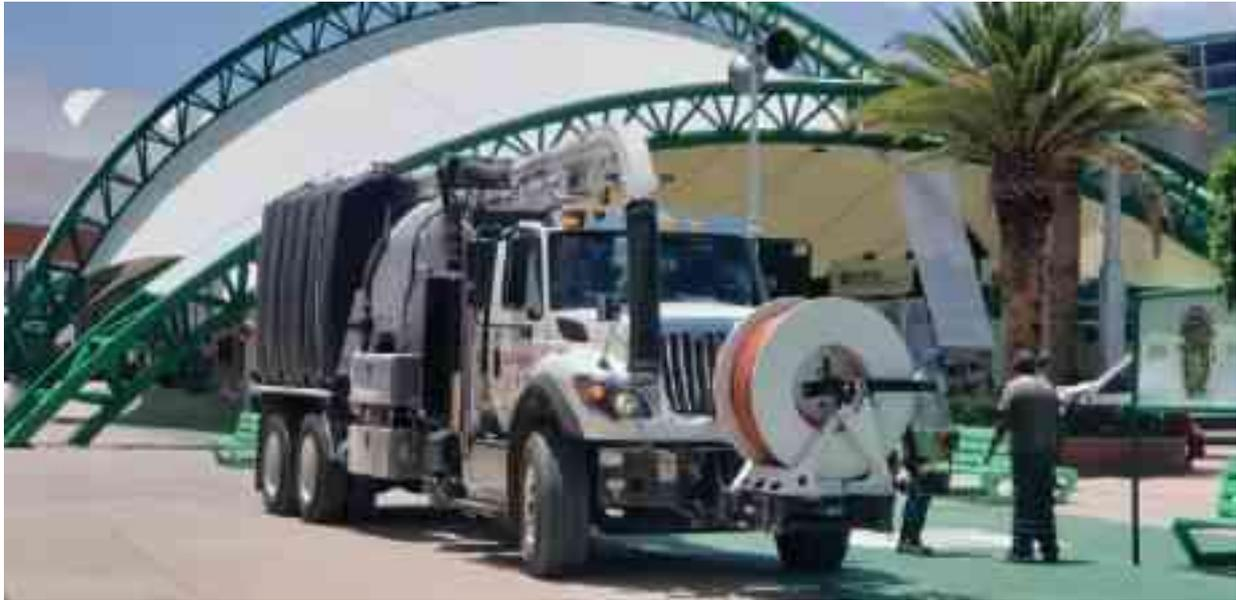
En este período se realizó la compra de 2 camiones hidroneumáticos con tecnología moderna para llevar a cabo la limpieza de la red de alcantarillado a cargo del Organismo Operador, estos camiones cuentan con una placa compactadora de lodos, lo cual optimiza la capacidad del tanque de desechos y reduce significativamente los tiempos de traslado al lugar de tiro, con lo cual se tiene un ahorro considerable también en el consumo de combustible
